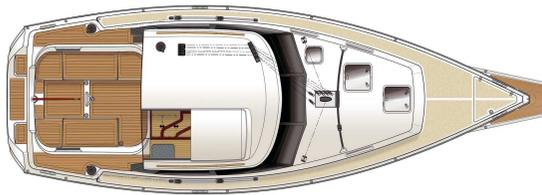
...sieht in der Draufsicht so aus (hinten das Cockpit, in der Mitte das Deckshaus, davor das Vorschiff auf dem der Mast steht)
